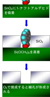
(B) 分子ふるいセンサの調製. 1-ナフタレンカルボン酸アニオンを鋳型として、細孔を有するシリカ層が表面を覆う.
